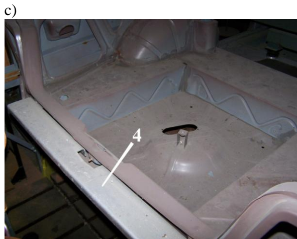
4-podstawa ustalająca położenie kątomierza w części tylnej nadwozia
