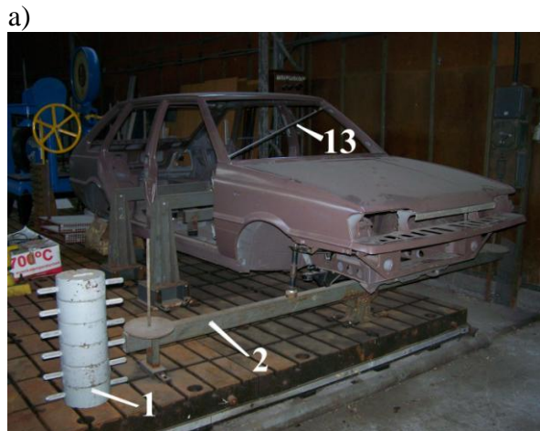
1-odważniki, 2-ramię obciążające, 13-poprzeczka (do obserwacji zmian długości przekątnej otworu szyby czołowej)
