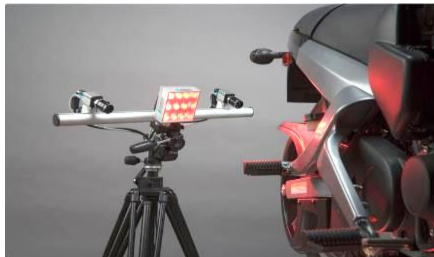
Badania wibracji stuktury motocykla
