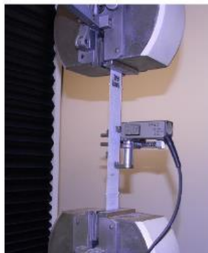
Próbka z założonym ekstensometrem przygotowana do badań z wykorzystaniem systemu DIC
