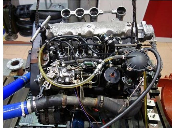
Silnik ZS PSA XUD9 (silnik badawczy do próby koksowania rozpylaczy)
