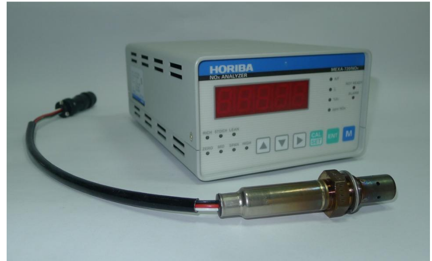
Horiba – mobilny analizator do pomiaru stężenia \text{NO}_x i \text{O}_2
