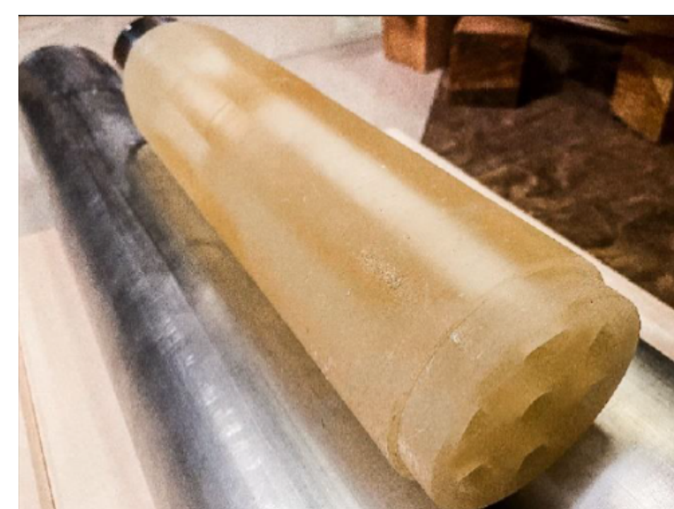
Rys. 3 Ziarno paliwa rakiety Twardowsky
