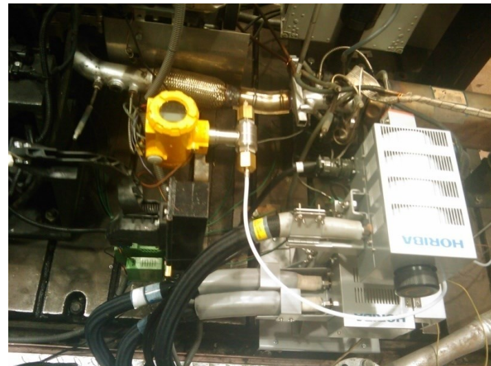
Układ poboru spalin firmy Horiba i aparatura do pomiaru ciśnienia spalin
