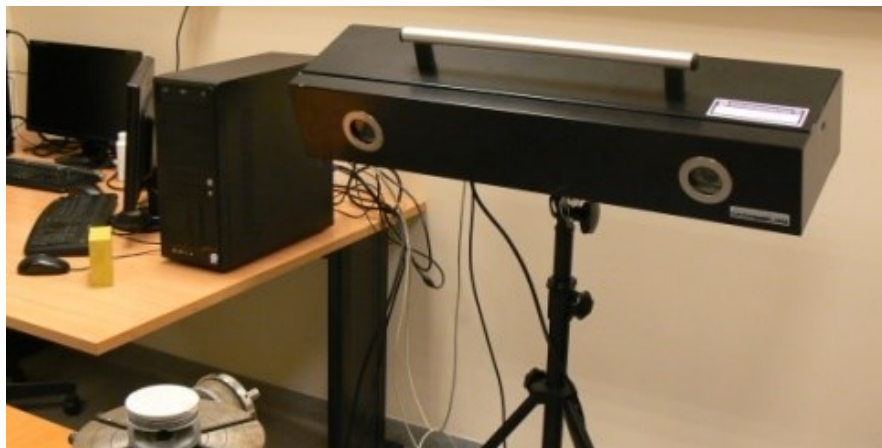
Pomiar tłoka na stanowisku ze skanerem 3D „ScanBright” firmy Smarttech
