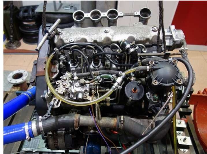
Silnik o ZS PSA XUD9 (silnik badawczy do próby koksowania rozpylaczy)
